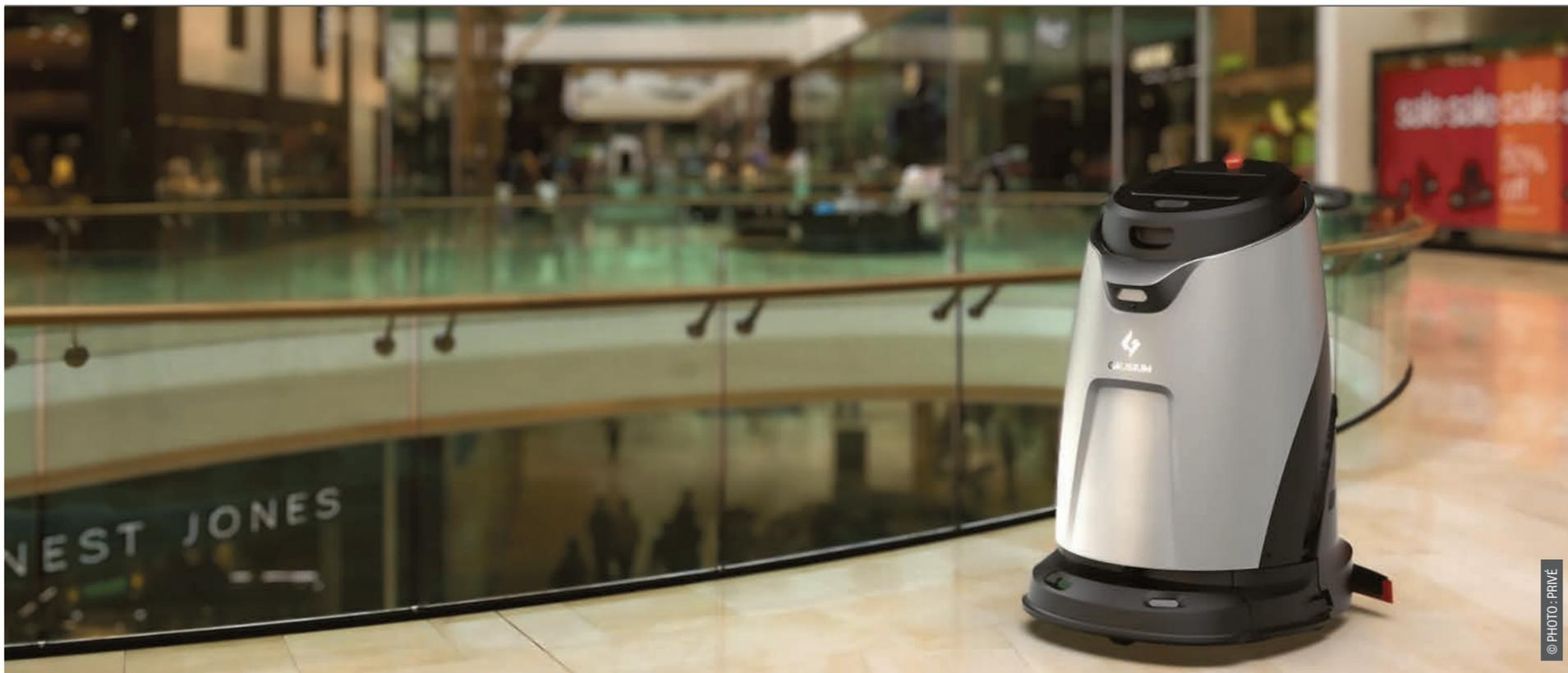
! Certaines autolaveuses se remplissent, se vident d'eau, se chargent en électricité et exécutent des tâches de façon entièrement autonome.
